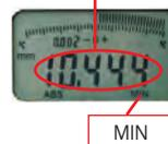
La funzione di ricerca del diametro minimo può trovare il diametro automaticamente
